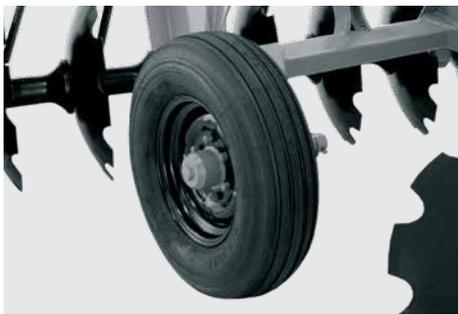
Rodeiro simples com pneu 600x16 para CRSG 12 a 16 discos. Rodeiro simples 7.50x16 para os modelos CRSG 18 a 28 discos.
